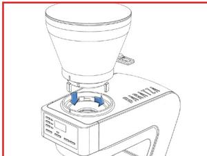
مع وجود غطاء الوعاء في مكانه ركب الوعاء بواسطة محاذة مقبض منع تسرب حبوب القهوة باتجاه الساعة ١١ (للخلف يساراً) اضغط الوعاء لأسفل وقم بالتدوير في اتجاه عقارب الساعة حتى انتظام المزالق في المقدمة بمحاذة بعضهما. اقلب مقبض منع تسرب حبوب القهوة الى وضع OPEN «مفتوح ثم أضف الكمية المرغوبة من حبوب القهوة المحمصة الكاملة
