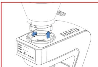
قم بتدوير مقبض من تسرب حبوب القهوة الى وضع مغلق CLOSED ثم بعد ذلك اضغط مفتاح البدء لإزالة اي بقايا لحبوب القهوة، قم بفصل كابل الطاقة من قابس الكهرباء ، أزل وعاء القهوة بتدويره عكس اتجاه عقارب الساعة حتى تتوقف ثم قم برفع وعاء حبوب القهوة من حسب المطحنة
