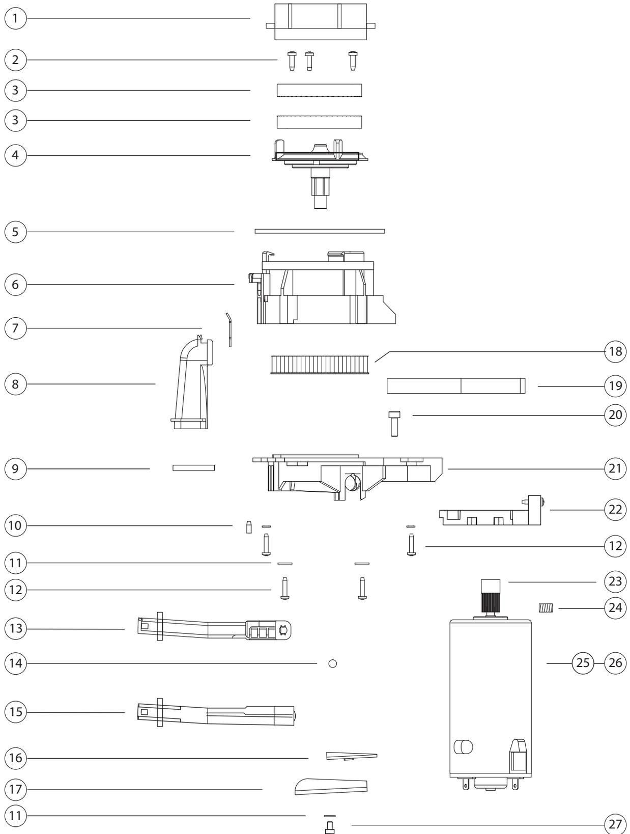
**Vario™+ Assemblage broyeur/moteur**
